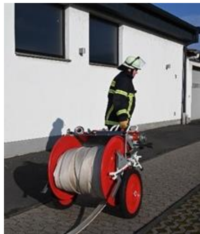
4.1.4-3 Auslegen eines Schlauches mit der Ein-Personen-Schlauchhaspel
