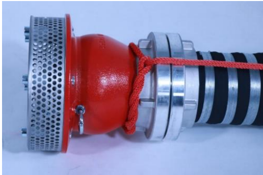
6.1-5 Sicherung des Saugkorbes mittels Zimmermannsschlages
