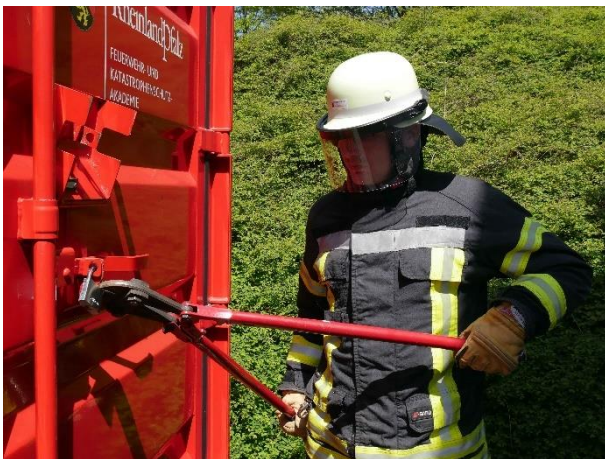
15.2-2 Bolzenschneider zum Öffnen eines Vorhängeschlosses
