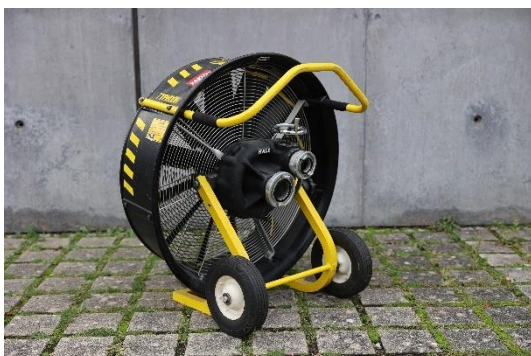
11-3 Belüftungsgerät mit Wasserturbinenantrieb
