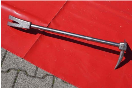
8.2-5 richtig abgelegtes multifunktionales Hebel-Brechwerkzeug
