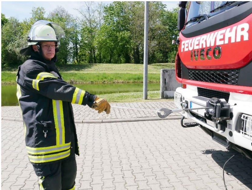
13.3-2 Aufspulen des Zugseils mit Halteschlaufe
