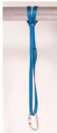
17.2.1-3 doppelter Ankerstich mit einer Bandschlinge
