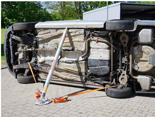
16.3-1 beispielhaftes Abstützen mit Abstützsystem
