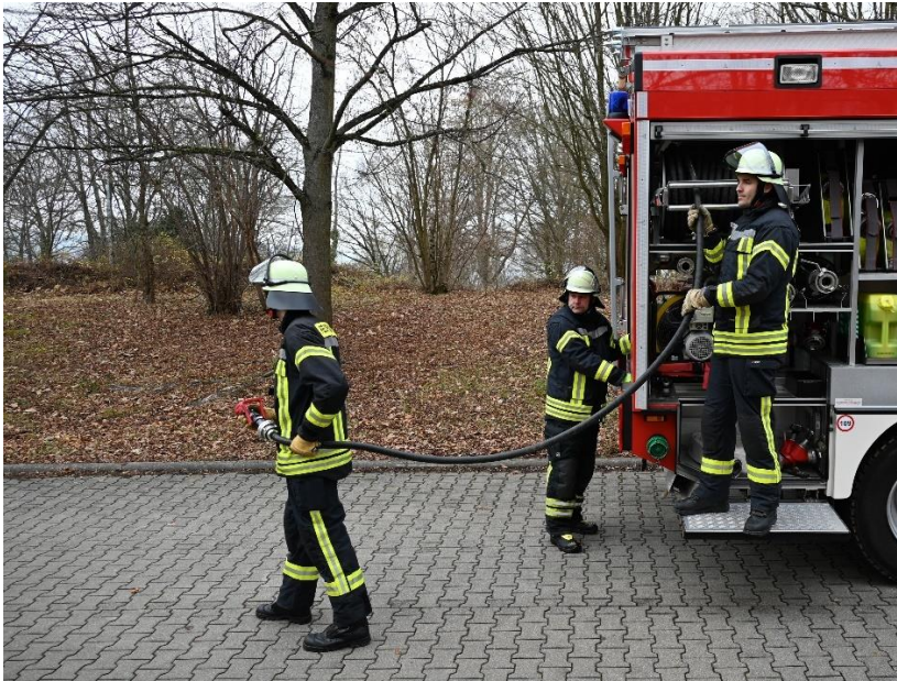
4.2-1 Vornahme der Einrichtung zur schnellen Wasserabgabe mit formstabilem Schlauch
