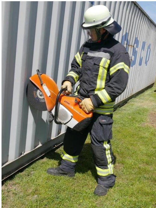
15.5-2 Verbrennungsmotor betriebene Trennschleifmaschine
