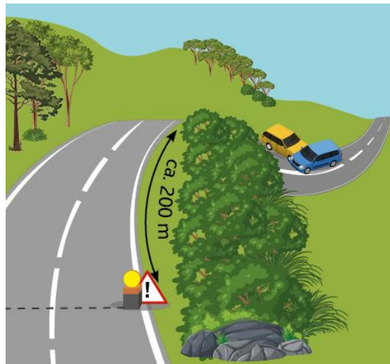
20.1-3 Vorwarnung auf eine Einsatzstelle hinter einer Kuppe
