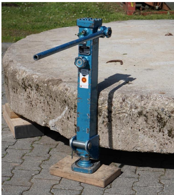
12.2-2 Hydraulische Winde beim Anheben einer Last
