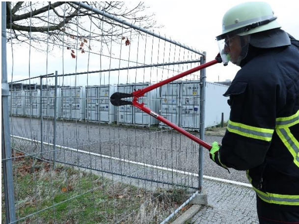
15.2-1 Bolzenschneider zum Trennen eines Zaunes
