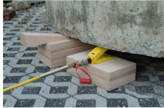
12.3-3 Spreizschnabel beim Heben einer Last
