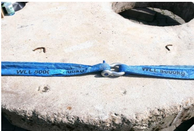
13.1.3-2 Verbinden von Rundschlingen mit einem geschweiften Schäkel
