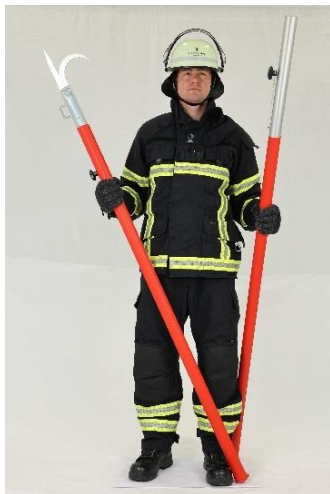
8.9-1 Einreißhaken aus Aluminium
