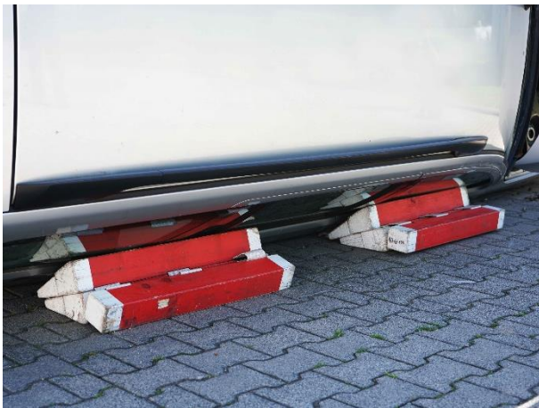
16.2-2 Beispielhafter Unterbau mit Schlauchbrücken
