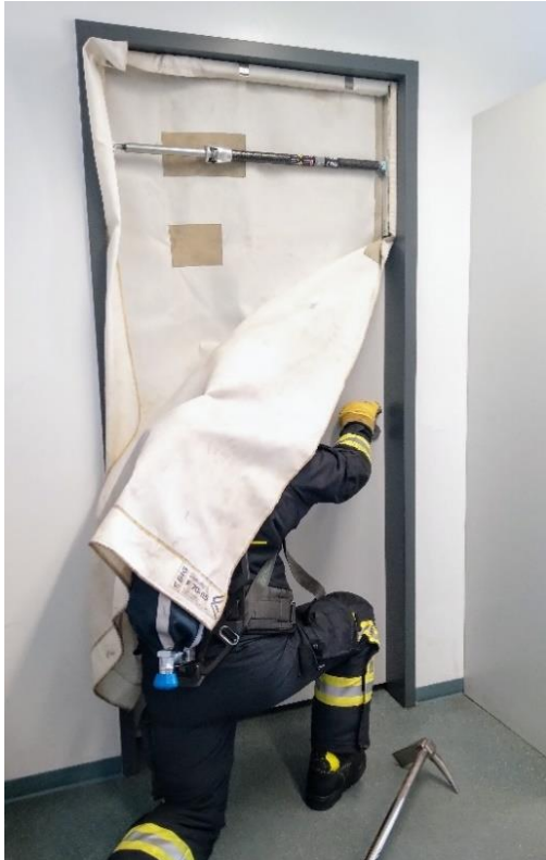
7.3-1 Mobiler Rauchverschluss im Einsatz
