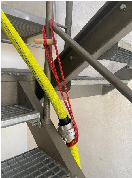
4.4.1-1 Entlastung der Schlauchleitung mittels eines Seilschlauchhalters
