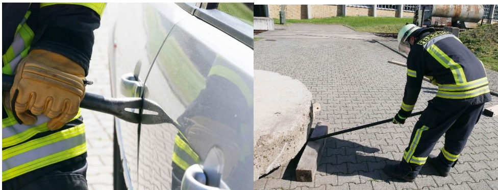
8.1-2 Ausgleichen der geringen Hubhöhe der Brechstange durch ein Kantholz beim Anheben
