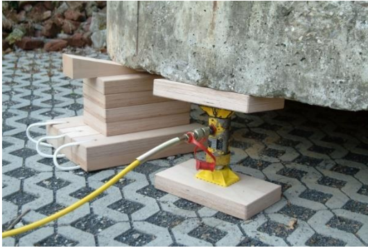
12.3-2 Hydraulischer Hebesatz beim Heben einer Last
