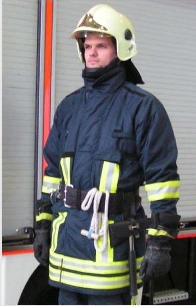
Feuerwehrhaltegurt mit Feuerwehrbeil
