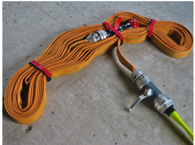
Abb. 20: Schlauchpaket wird über das Absperrorgan mit der Zuleitung verbunden.
