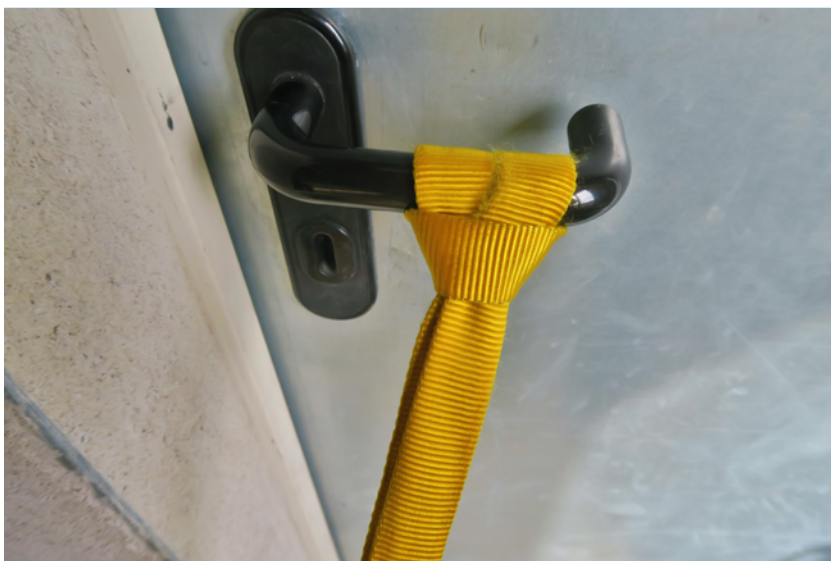
Abb. 25: Befestigung der Bandschlinge mittels doppeltem Ankerstich, dadurch wird ein Abrutschen der Bandschlinge verhindert.
