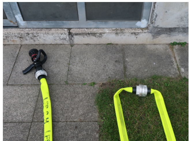
Abb. 10: Hohlstrahlrohr und Schläuche sind gekuppelt.
