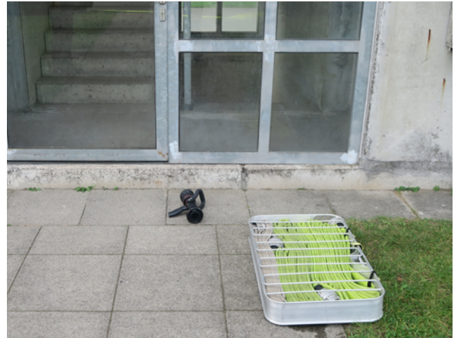
Abb. 12: Schlauchtragekorb positioniert vor dem Gebäude
