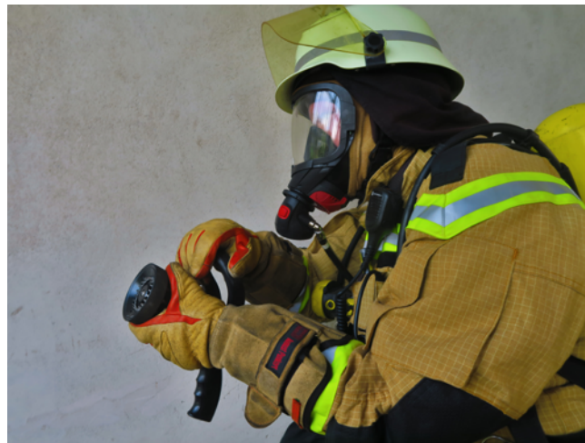
Abb. 38: Empfohlene Haltung des Hohlstrahlrohres bei der dynamischen Strahlrohrführung. Das Strahlrohr wird am Strahlregler gehalten, der Pointer auf der 12 Uhr Position dient der Orientierung. Die Verstellung des Strahlbildes erfolgt über die Drehung des Absperrorgans.
