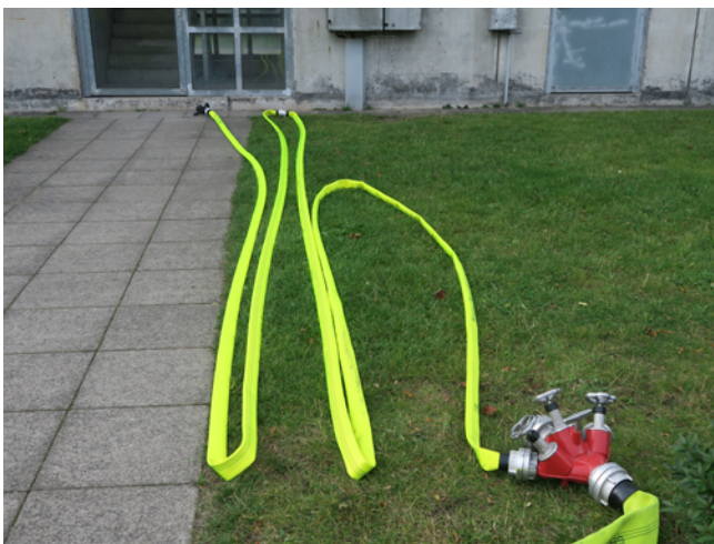
Abb. 9: Hohlstrahlrohr, Schläuche und Verteiler sind gekuppelt.
