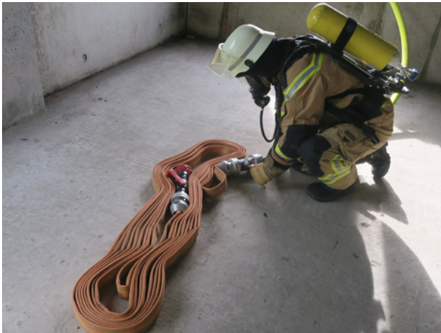
Abb. 21: Das Schlauchpaket wird befüllt, das angeschlossene Strahlrohr wird aus dem Paket heraus abgelegt, um eventuelle Verknotungen zu vermeiden.
