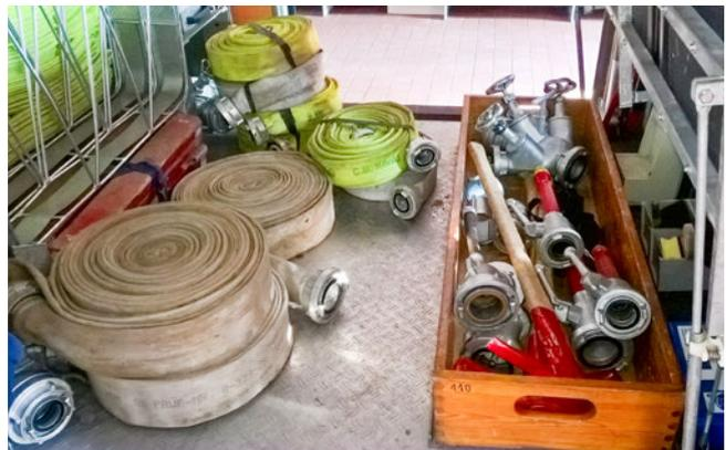
Abb. 4: Unzulässig lose gelagerte Ausrüstungsgegenstände
