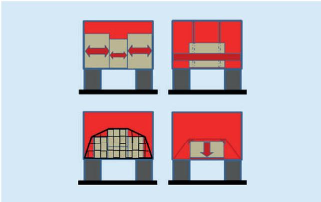
Abb. 5: Schematische Darstellung einer optimalen Ladungssicherung im Fahrzeug
